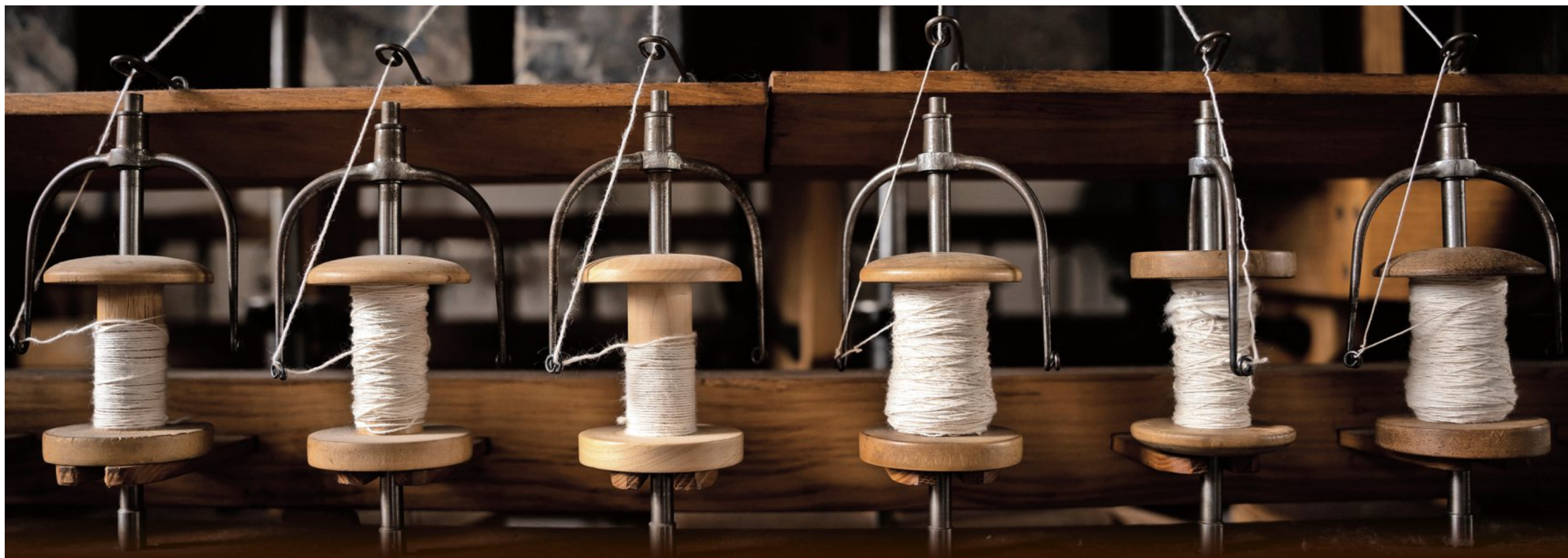
Heute wie damals wird Garn mit der Spinnmaschine in Ratingen verzwirnt und aufgespult.
