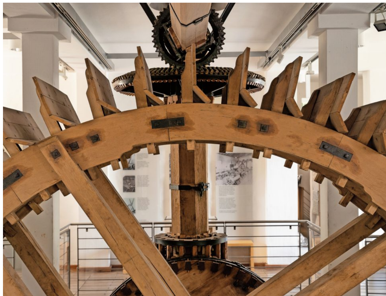
Das große Wasserrad samt der Königswelle, das alle Maschinen der Ratinger Fabrik am Laufen hält.
