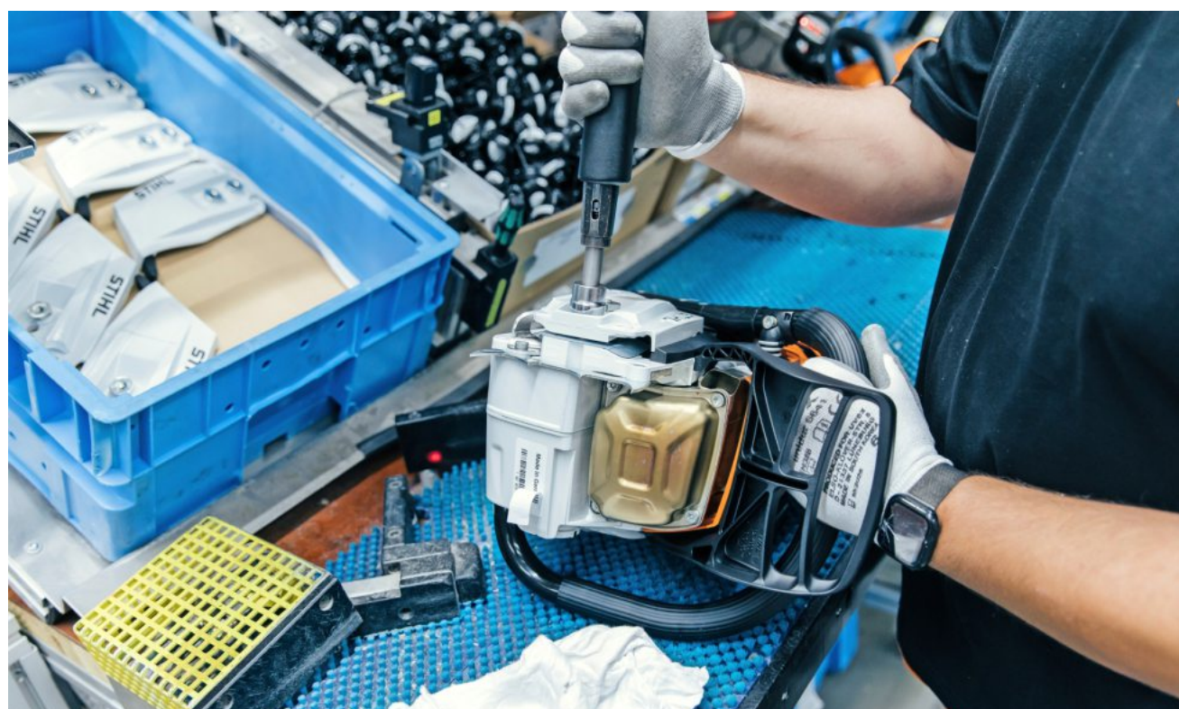
Schrauben, drücken, kleben: Eine Motorsäge entsteht.
