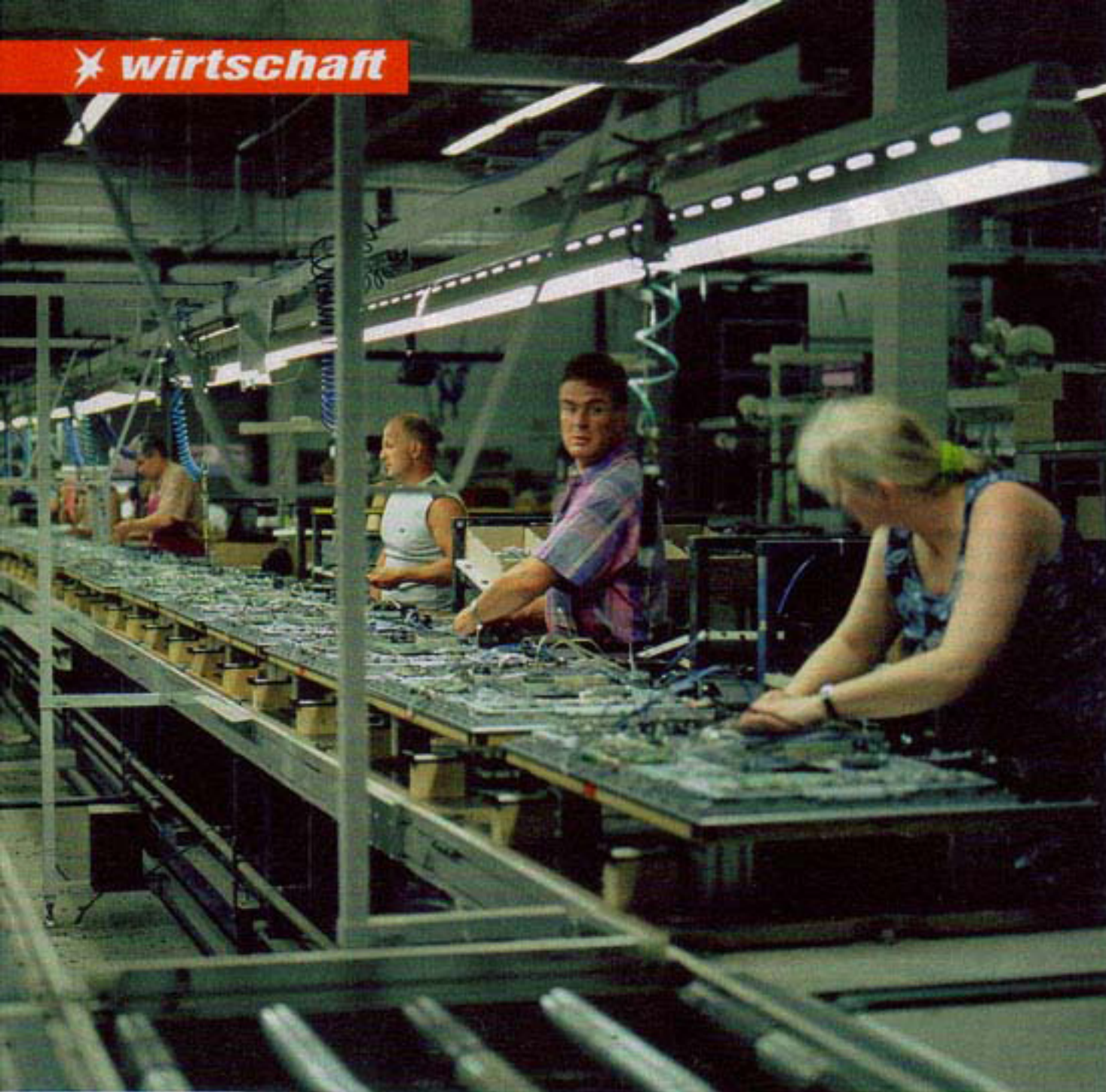
Es ist nicht China – es ist mitten in Deutschland: Per Hand werden im Loewe-Werk Platinen verkabelt. Die Kunden geben für die hochwertigen Geräte rund 1000 Euro mehr aus als für Massenware
